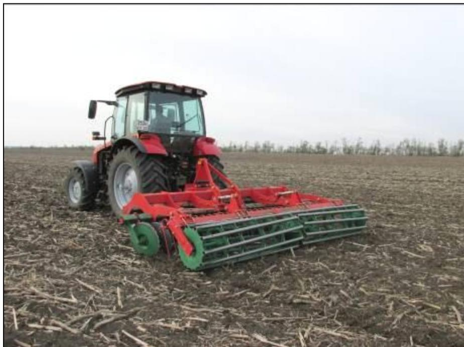
Рисунок 3 - Трактор Беларус 1523 в агрегате с дисковым луцільнікам UNIA ARES 4TXL, на дисковым луцении стерни подсолнечника (2-й след)
