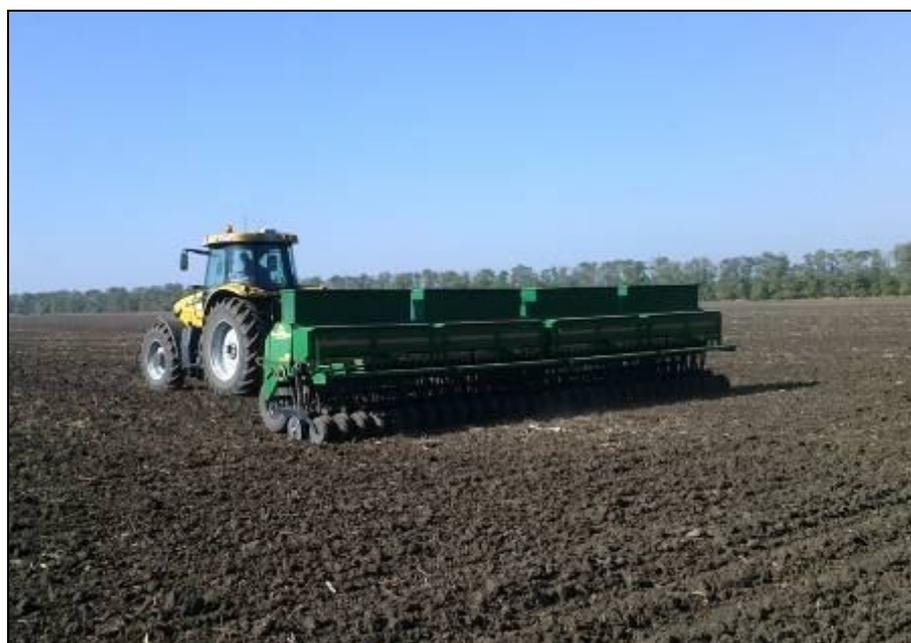
Рисунок 4 – Трактор Challenger МТ-575В с сеялкой мод. 2SF-30 Great Plains на посеве пшеницы
