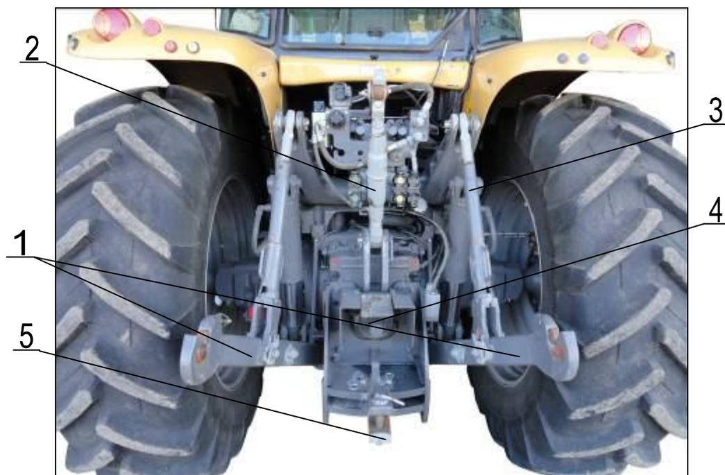
Рисунок 3 – Заднее навесное устройство НУ-3:
