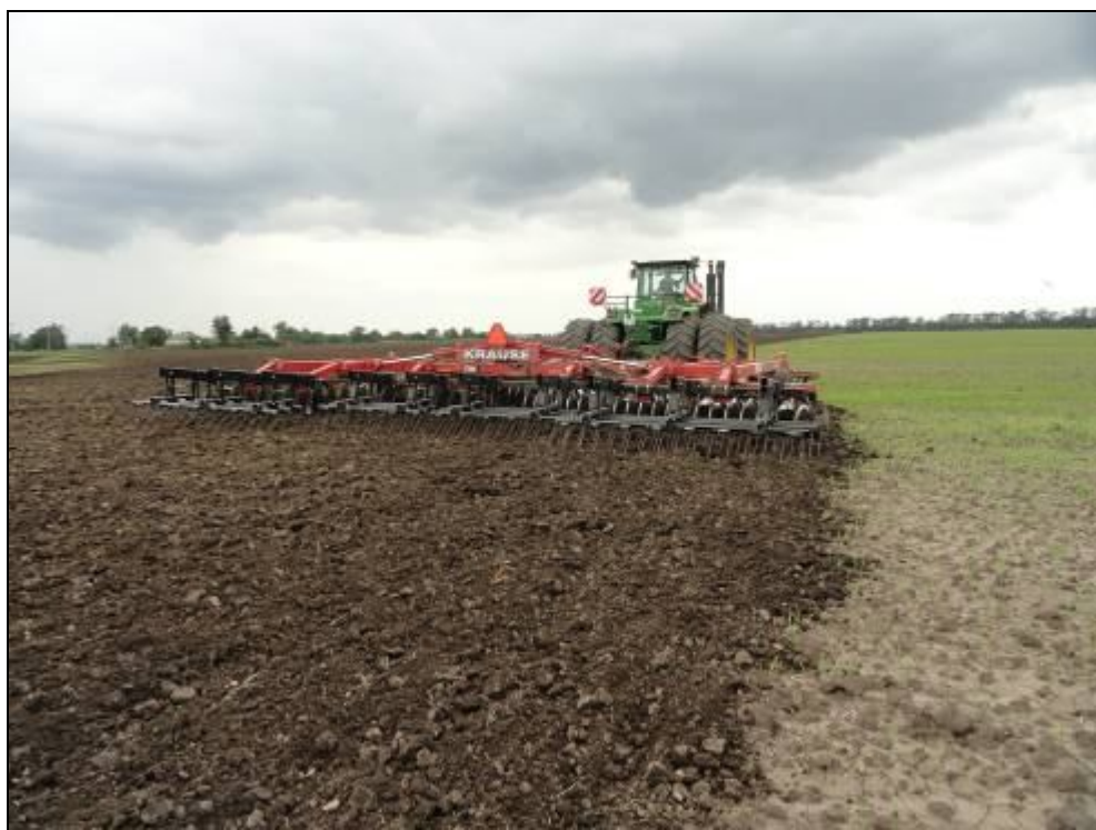
Рисунок 4 – Трактор John Deere 9460R в агрегате с бороной дисковой KRAUSE 8200 на дисковом лущении стерни озимой пшеницы (3-й след)
