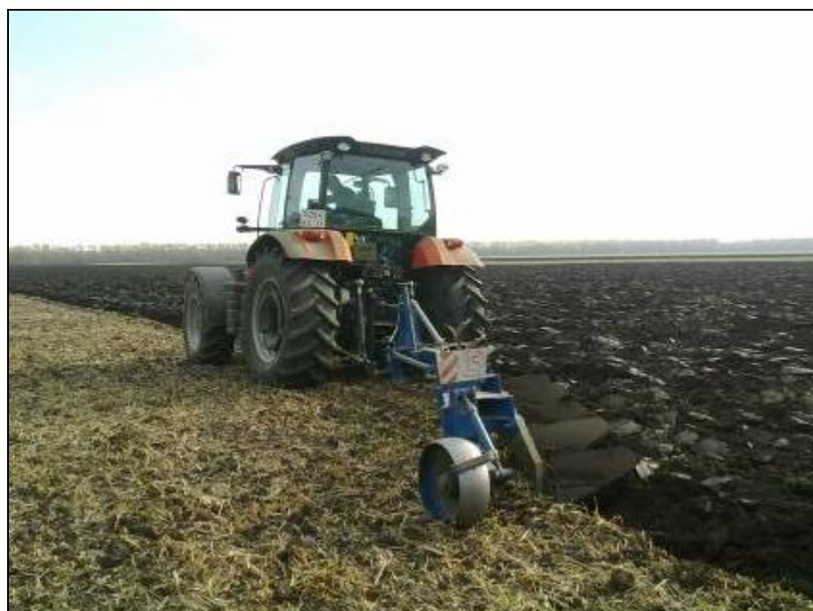
Рисунок 3 – Трактор АТМ 3180М в агрегате с плугом ПНР-(4+1)×45П на отвальной вспашке почвы
