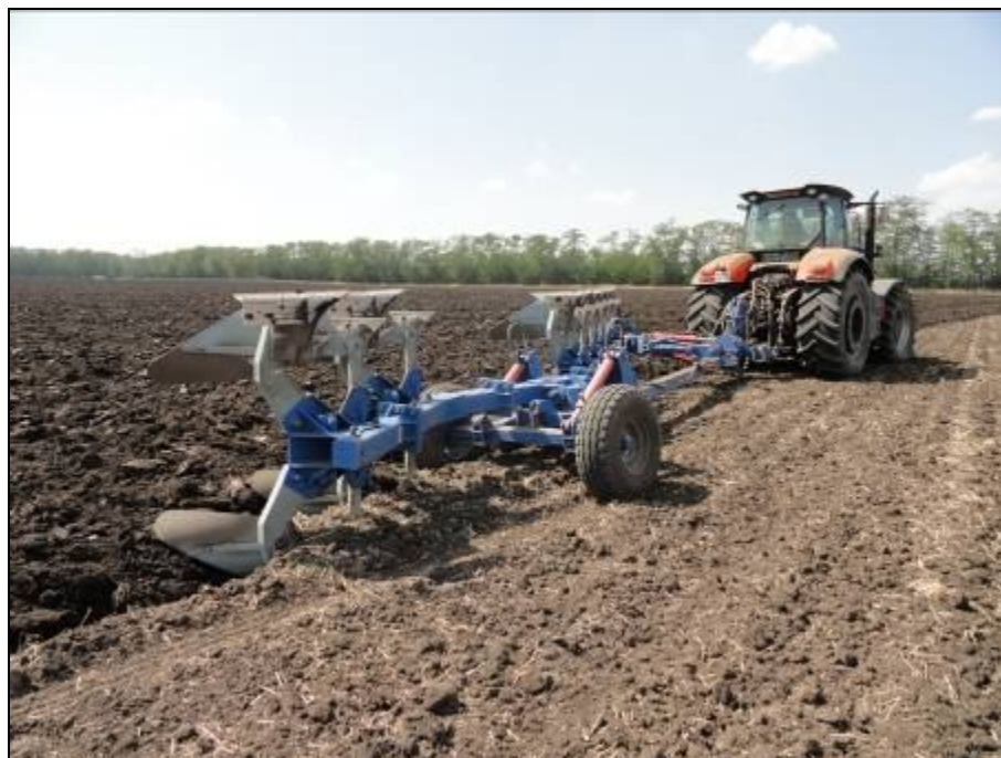
Рисунок 6 – Трактор АТМ 7360 в агрегате с плугом ППО-(5+1+1)х40П, на отвальной вспашке почвы после дискового лущения стерни пшеницы (3 след)
