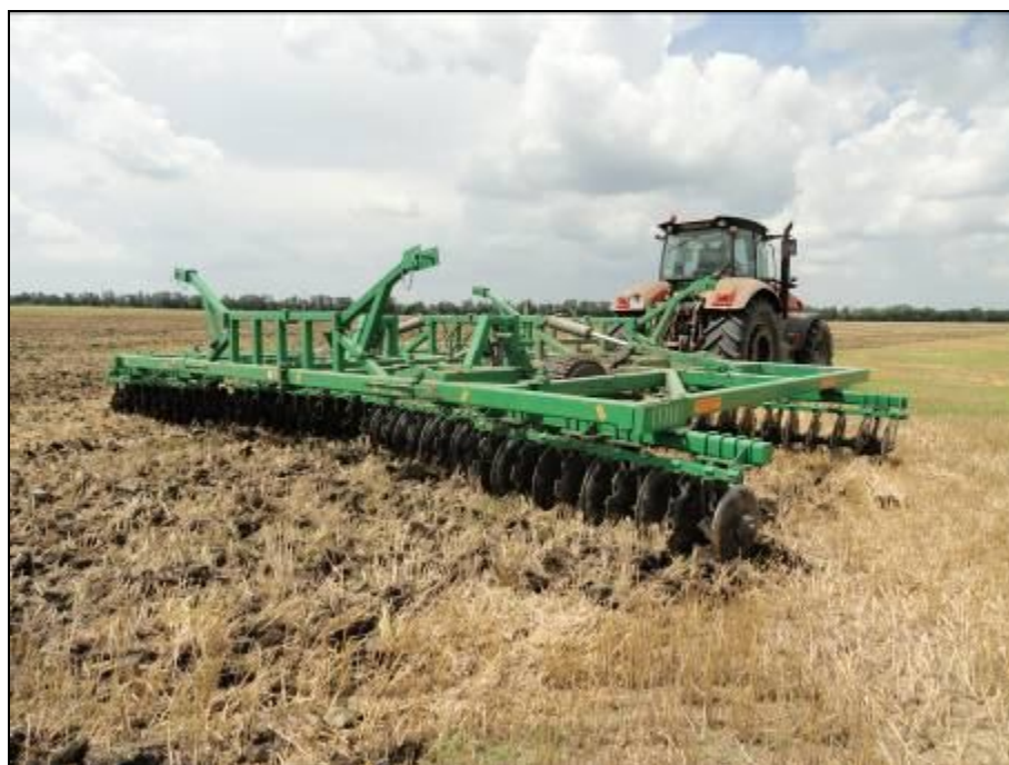
Рисунок 3 – Трактор АТМ 7360 в агрегате с бороной БД-9,3, на дисковом лушении стерни озимой пшеницы (1 след)
