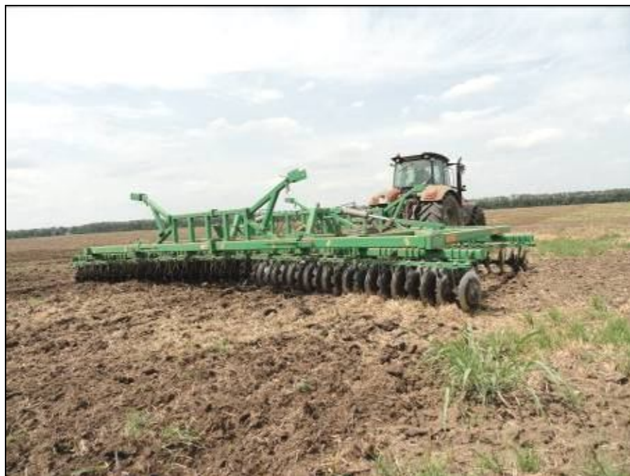
Рисунок 4 – Трактор АТМ 7360 в агрегате с бороной БД-9,3, на дисковом лущении стерни озимой пшеницы (2 след)
