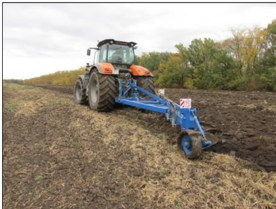
Рисунок 8 – Трактор АТМ 7360 в агрегате с плугом ПНУ-6х35П, на отвальной вспашке почвы после дискового лущения стерни пшеницы
