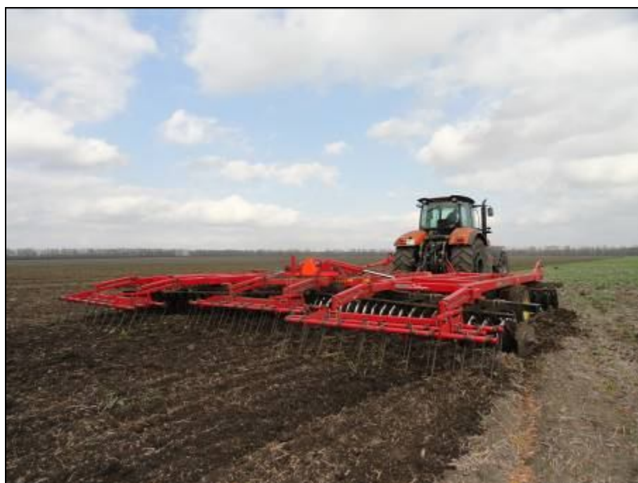
Рисунок 7 – Трактор АТМ 7360 в агрегате с бороной Challenger- 1435, на дисковом лущении стерни озимой пшеницы (2 след)
