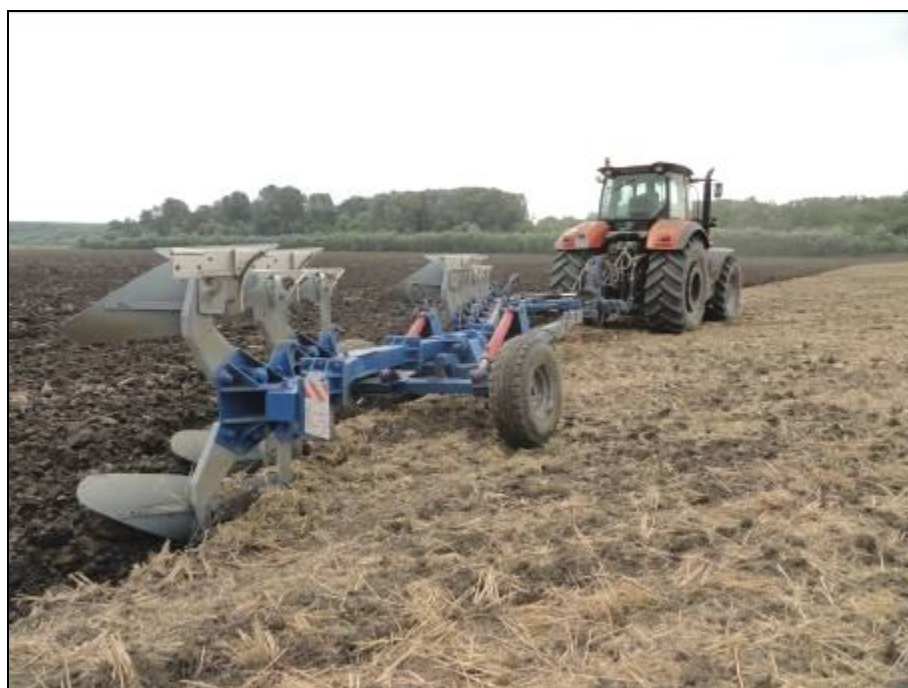
Рисунок 5 – Трактор АТМ 7360 в агрегате с плугом ППО-(5+1+1)х40П, на отвальной вспашке почвы после дискового лущения стерни пшеницы (1 след)
