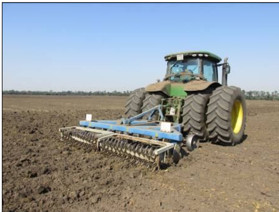
Рисунок 4 – Трактор JOHN DEERE 8310R в агрегате с плугом чизельным ПЧН-4,0, на чизелевании почвы
