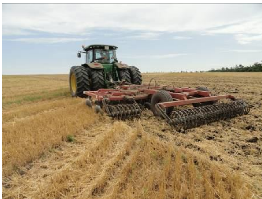
Рисунок 3 – Трактор JOHN DEERE 8310R в агрегате с дискаторм БДМ-5х4ПК, на дисковом лушении стерни озимой пшеницы (1 след)
