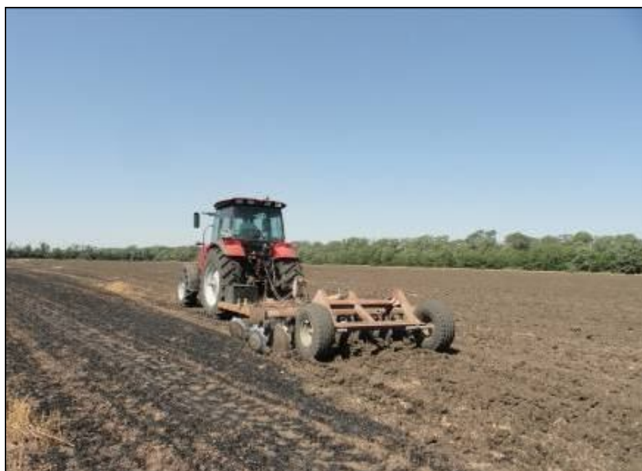
Рисунок 3 – Трактор колесный Беларус 2022.3 в агрегате с дисковой бороной БДМ-3×4 на дисковом лушении стерни озимой пшеницы (1 след)
