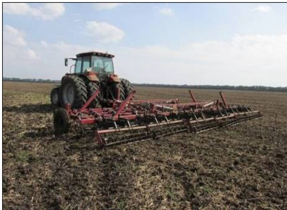
Рисунок 4 – Трактор колесный Беларус 2022.3 в агрегате с культиватором КПМ-10 на осенней предпосевной культивации почвы
