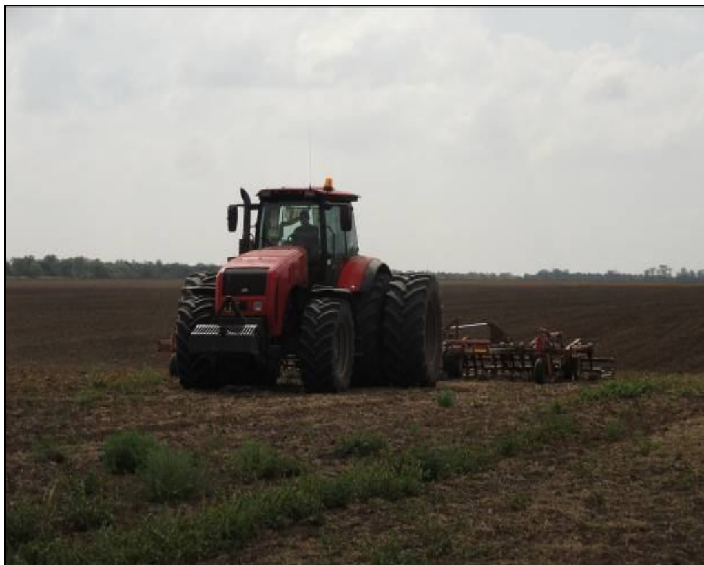
Рисунок 4 – Трактор "Беларус" 3522 в агрегате с культиватором Краузе, на предпосевной культивации
