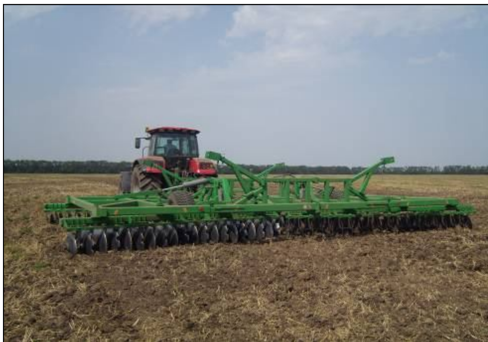
Рисунок 3 – Трактор "Беларус" 3522 в агрегате с бороной БД-9,3, на дисковом лущении стерни озимой пшеницы
