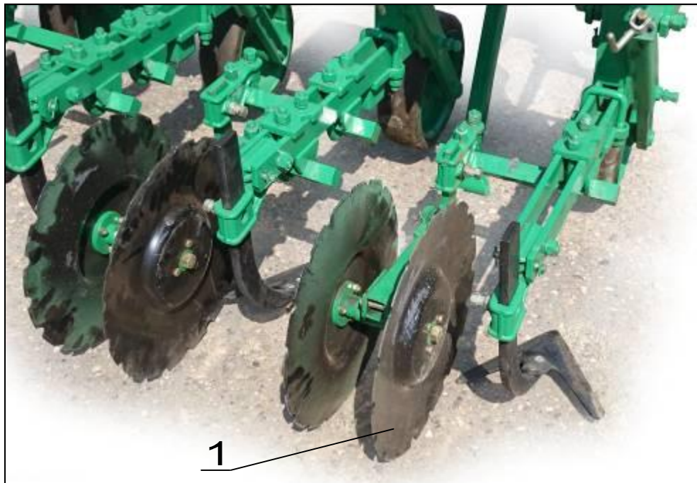
Рисунок 4 – Секция рабочих органов с защитными дисками и стрельчатой лапой: 1 - диски защитные
