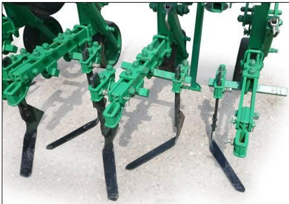
Рисунок 5 – Секция рабочих органов с лапами полольными односторонними
