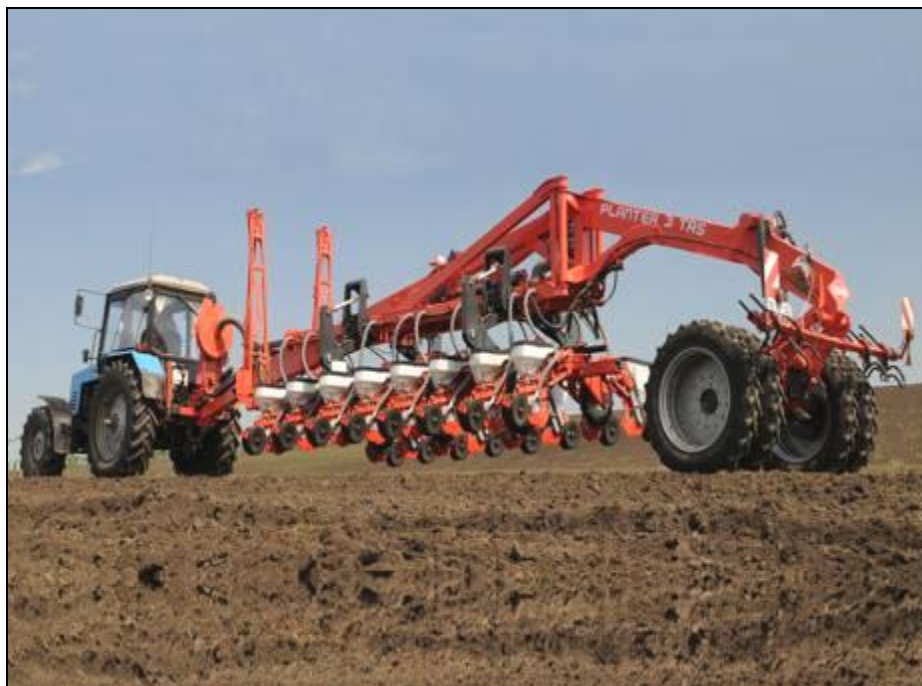
Рисунок 3 – Сеялка пропашная KUHN Planter 3 TRS, в транспортном положении
