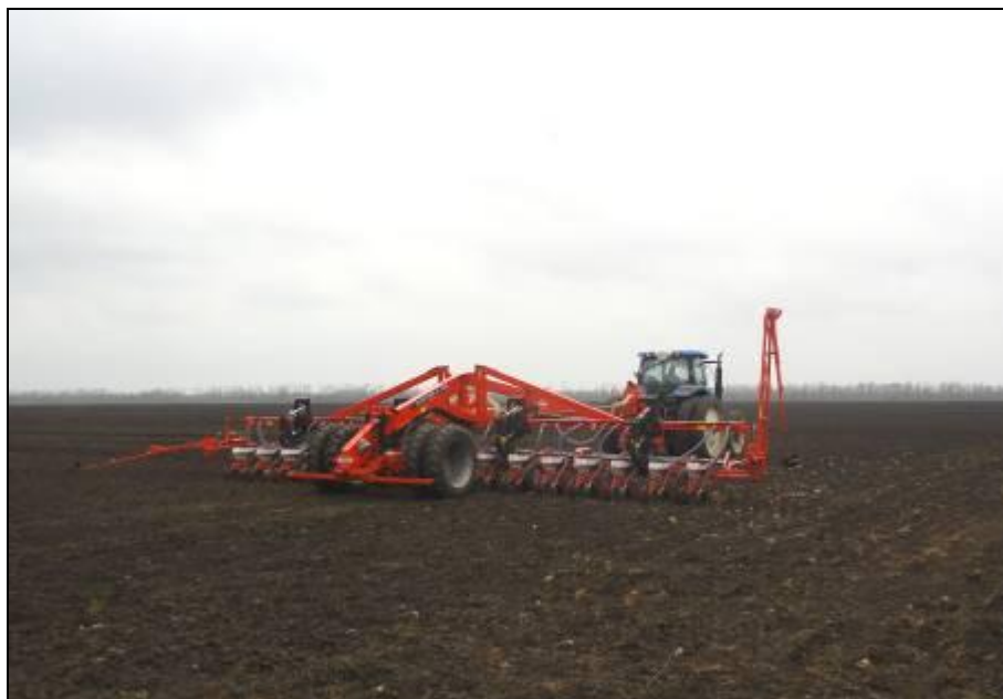
Рисунок 5 – Сеялка пропашная KUHN Planter 3 TRS в агрегате с трактором New Holland 7050 на посеве кукурузы
