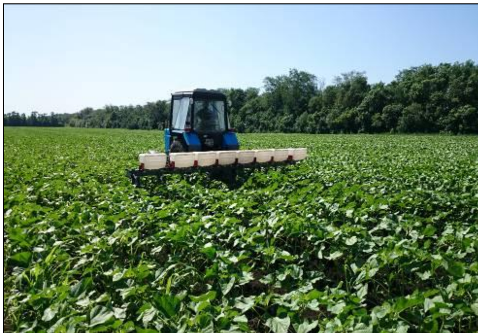
Рисунок 2 – Культиватор навесной для высокостебельных культур КРН-5,6В в агрегате с трактором Беларус 82.1, на междурядной культивации подсолнечника (в комплектации с лапами рыхлительными)
