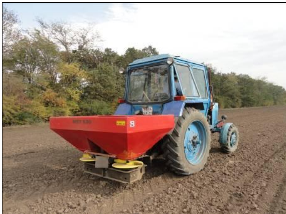
Рисунок 2 – Машина для внесения минеральных удобрений МВУ-900 в агрегате с трактором МТЗ-82 на внесении удобрений
