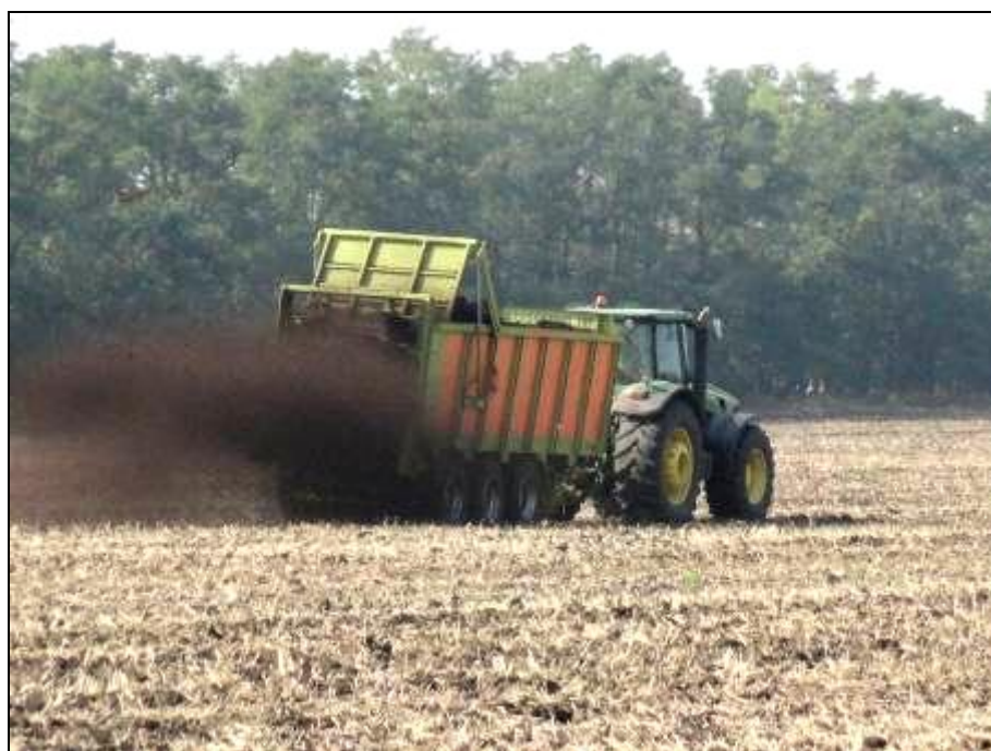
Рисунок 3 – Разбрасыватель органических удобрений многофункциональный РОУМ-20 в агрегате с трактором John Deere 8430, в работе
