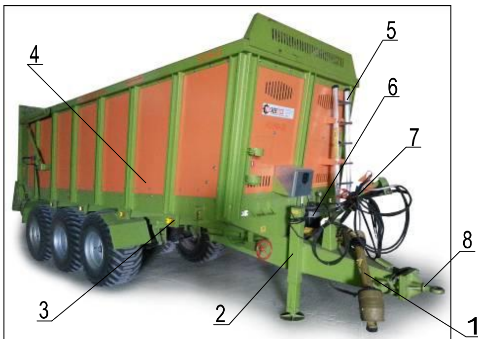
Рисунок 1 – Разбрасыватель органических удобрений многофункциональный РОУМ-20, вид спереди справа: 1 - карданный вал; 2- гидравлическая опорная стойка; 3 - рама; 4 - облицовка кузова; 5 - лестница; 6 - насос гидросистемы натяжения цепи транспортера; 7 - гидросистема; 8 - сница
