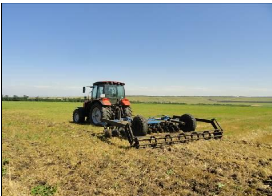
Рисунок 3 – Борона дисковая БДУ-4х2П в агрегате с трактором Беларус 1523В, на дисковом лущении стерни озимой пшеницы (1-й след)
