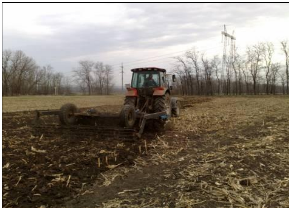
Рисунок 2 – Борона дисковая БДУ-4х2П в агрегате с трактором Беларус 1523В, на дисковом лущении стерни кукурузы (2-й след)
