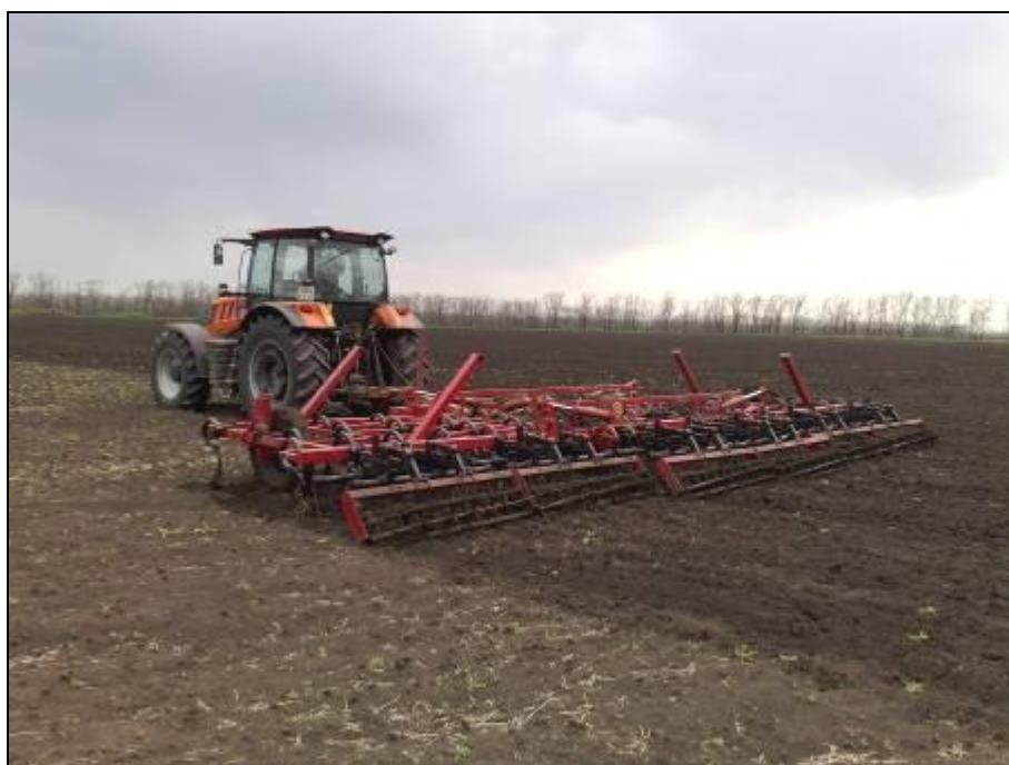
Рисунок 6 – Культиватор КПМ-10 в агрегате с трактором АТМ-3180М, на весенней предпосевной культивации почвы
