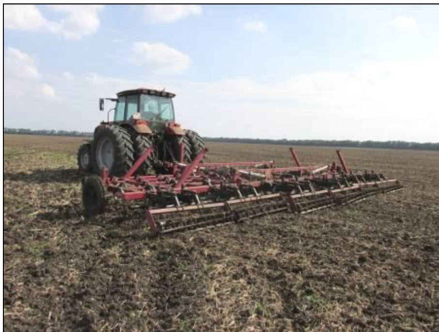
Рисунок 7 – Культиватор КПМ-10 в агрегате с трактором Беларус 2022.3, на осенней предпосевной культивации почвы
