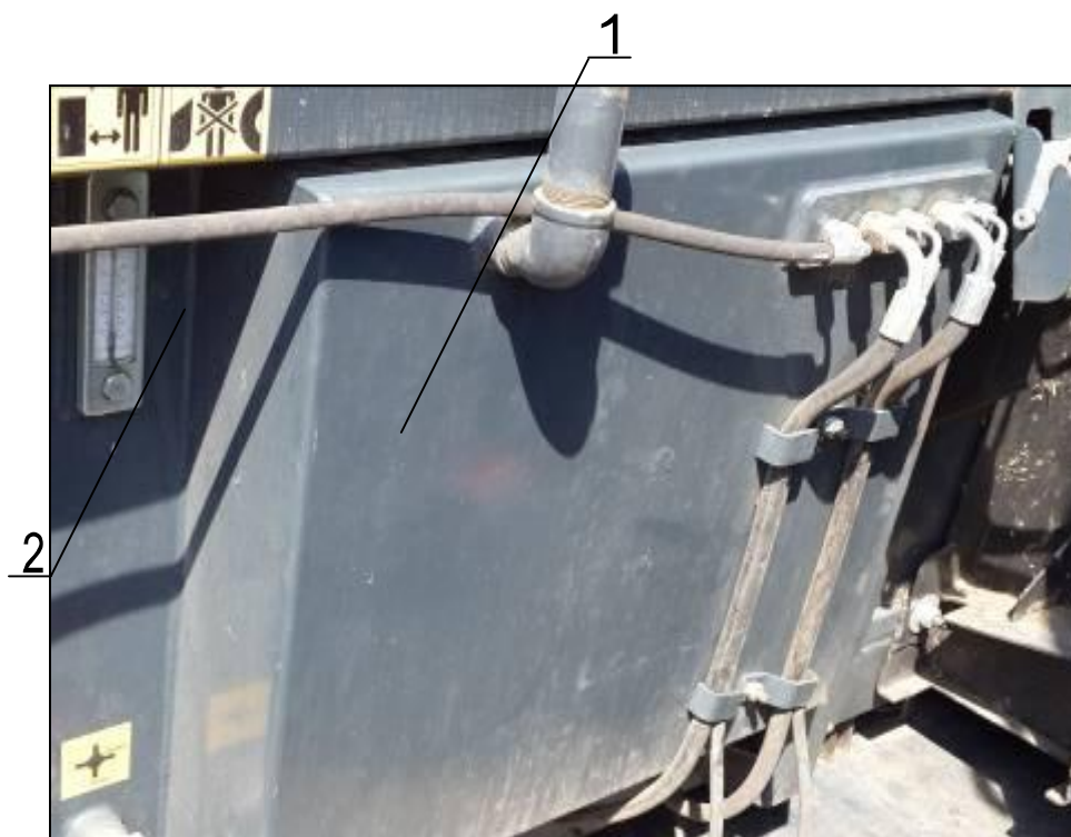
Рисунок 6 – Гидравлический резервуар: 1 - гидравлический резервуар; 2 - термометр
