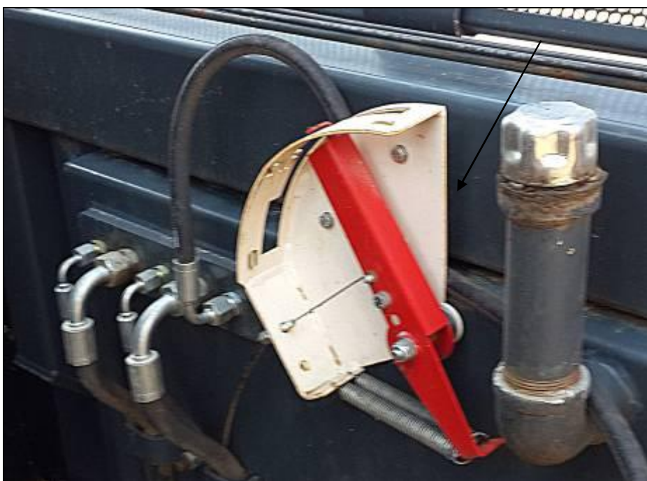
Рисунок 5 – Измеритель высоты стерни
