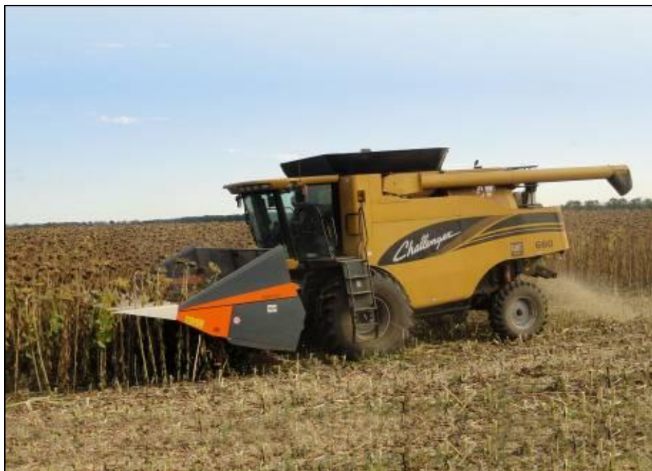
Рисунок 8 – Приспособление OptiSun-870-PSM в агрегате с самоходным зерноуборочным комбайном Challenger 660 на уборке подсолнечника
