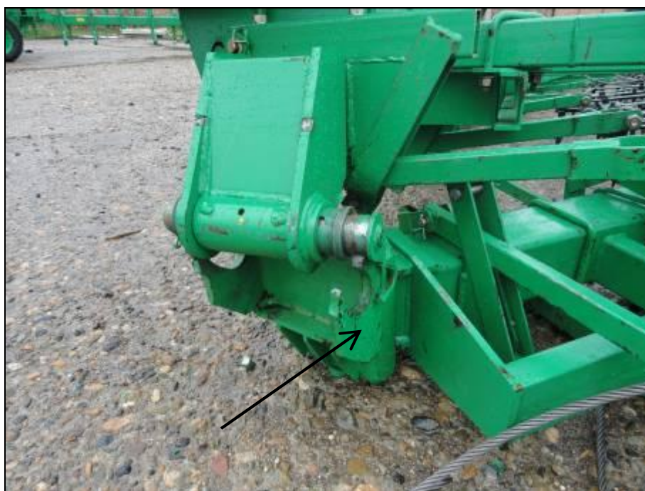
Рисунок 6 – Разрыв крестовины СГ21К 00.020
