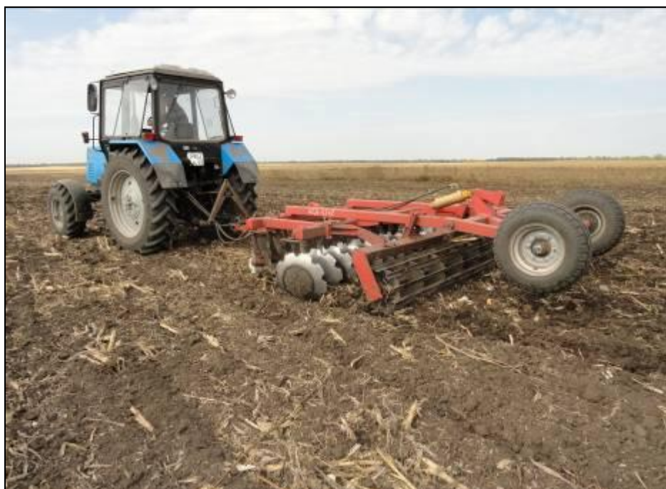
Рисунок 3 – Борона дисковая АБД-3,2х2 в агрегате с трактором МТЗ-892, вид в работе на стерне кукурузы (2 след)
