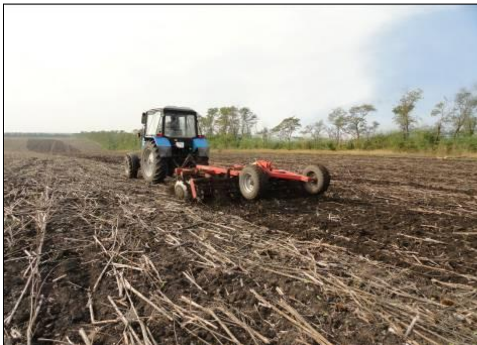
Рисунок 2 – Борона дисковая АБД-3,2х2 в агрегате с трактором МТЗ-892, вид в работе на стерне подсолнечника (2 след)
