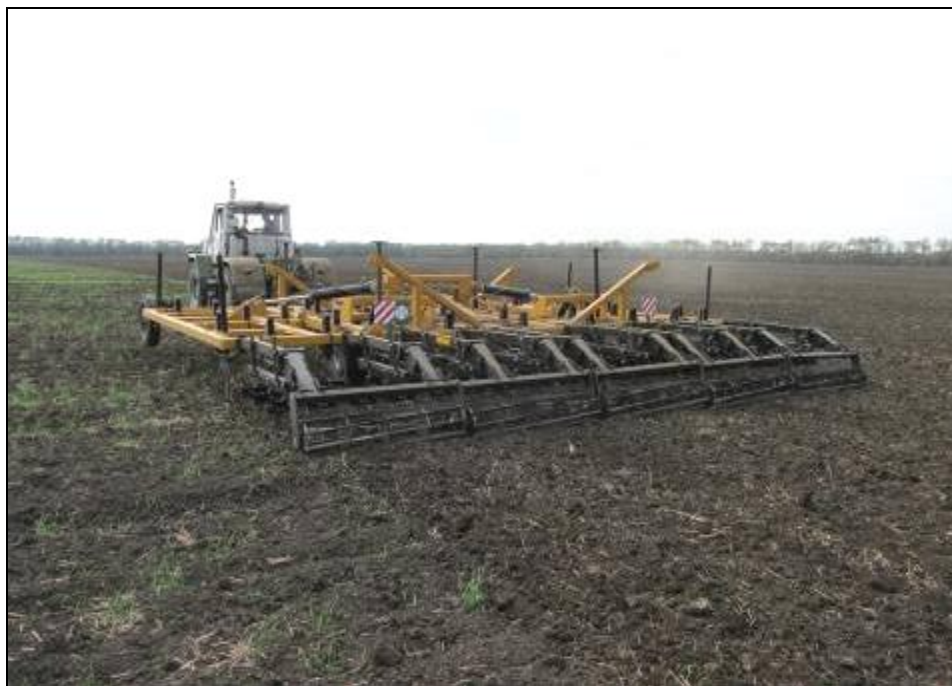
Рисунок 2 – Культиватор "Престиж" К1 7.0 в агрегате с трактором Т-150К на сплошной обработке почвы
