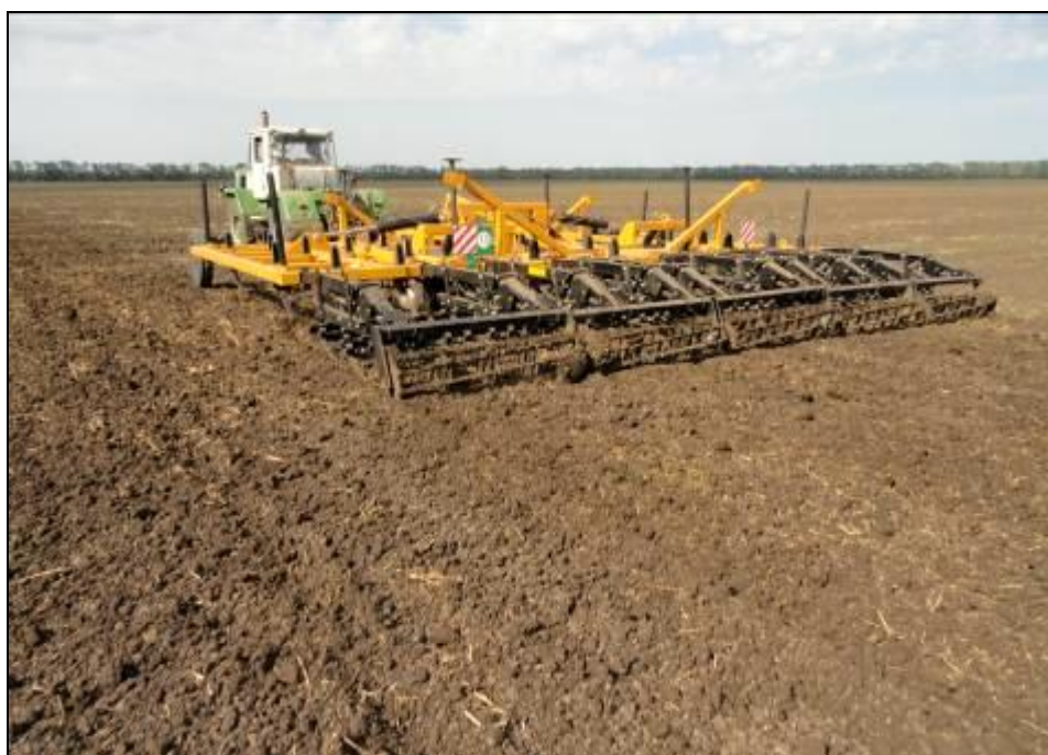
Рисунок 3 – Культиватор "Престиж" К1 7.0 в агрегате с трактором Т-150К на предпосевной обработке почвы
