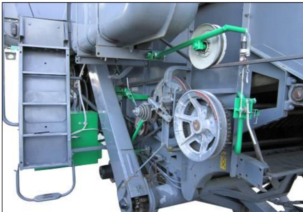
Рисунок 1 – НС-4 Натяжник привода от заднего контрпривода на зерновой шнек комбайна "НИВА", вид сзади слева
