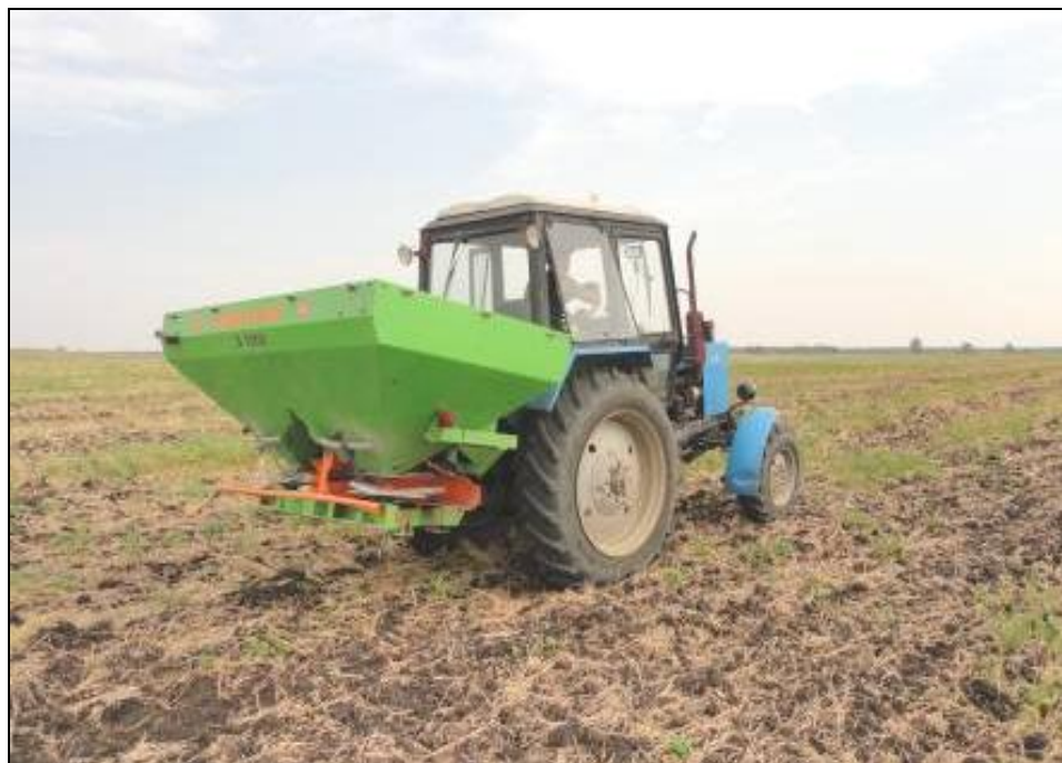
Рисунок 2 – Машина для внесения минеральных удобрений МВУ-1500 в агрегате с трактором МТЗ-82 в работе
