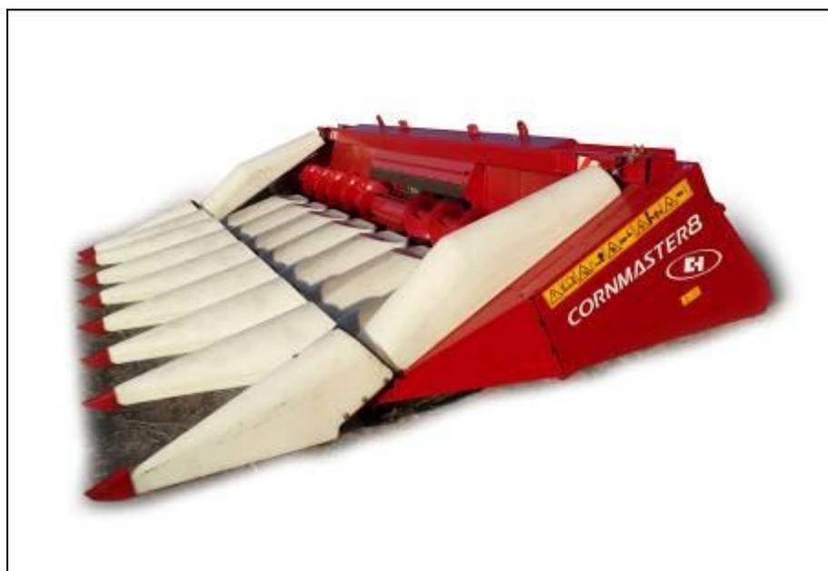
Рисунок 1 – Приспособление для уборки кукурузы "CORNMASTER 8", вид спереди слева
