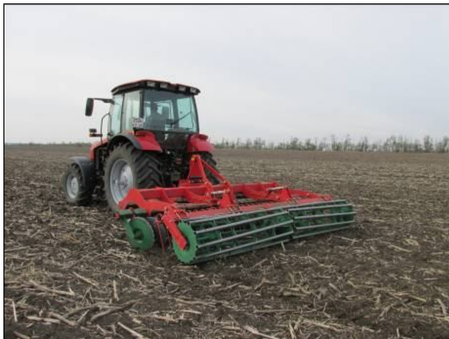
Рисунок 4 – Дисковый луцильник UNIA ARES 4TXL в агрегате с трактором Беларус 1523, на дисковом лущении стерни подсолнечника (2-й след)
