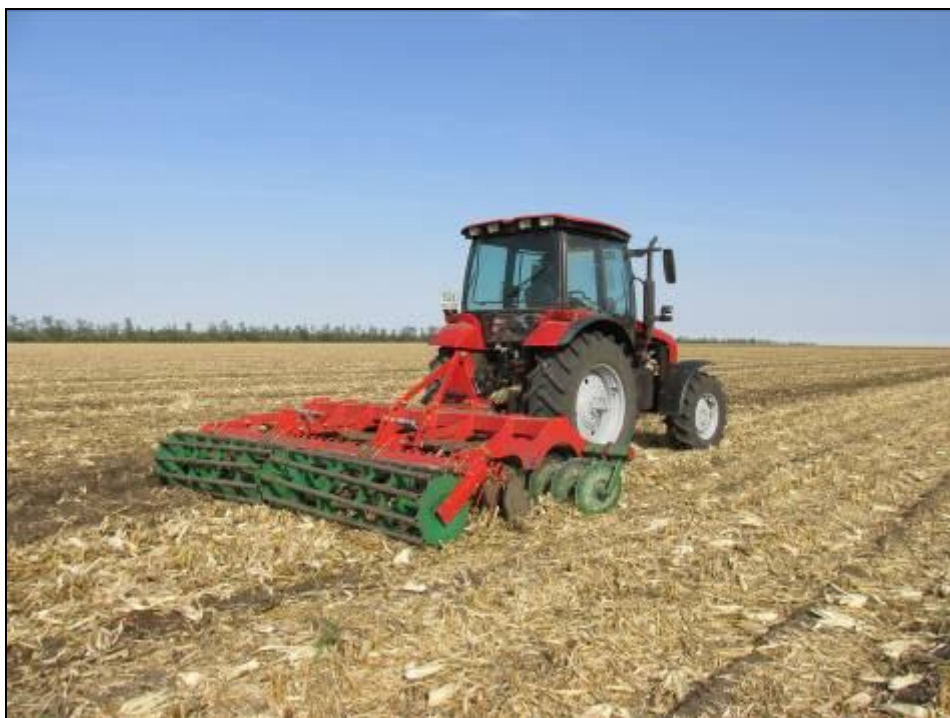
Рисунок 3 – Дисковый луцильник UNIA ARES 4TXL в агрегате с трактором Беларус 1523, на дисковом луцении стерни кукурузы (1-й след)
