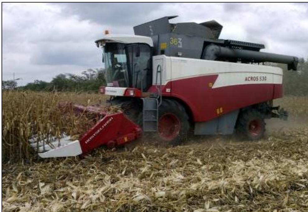
Рисунок 2 – Приспособление ППК-81-01 в агрегате с зерноуборочным комбайном РСМ-142 "ACROS-530" на уборке кукурузы на зерно
