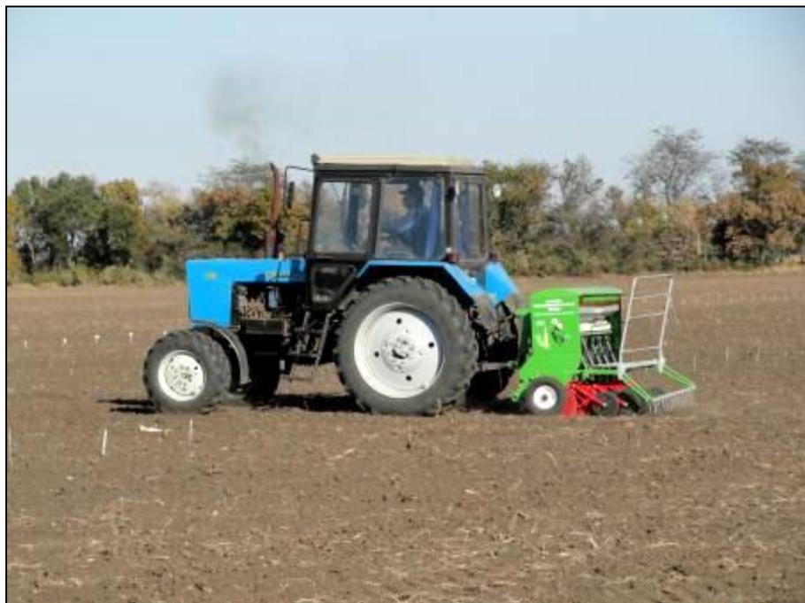
Рисунок 2 – Сеялка селекционная "СС-11" в агрегате с трактором МТЗ-82.1 на посеве озимой пшеницы
