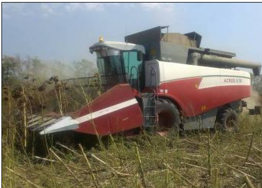
Рисунок 2 – Приспособление для уборки подсолнечника ПСП-810, в агрегате с зерноуборочным комбайном РСМ-142 "ACROS-530" на уборке подсолнечника
