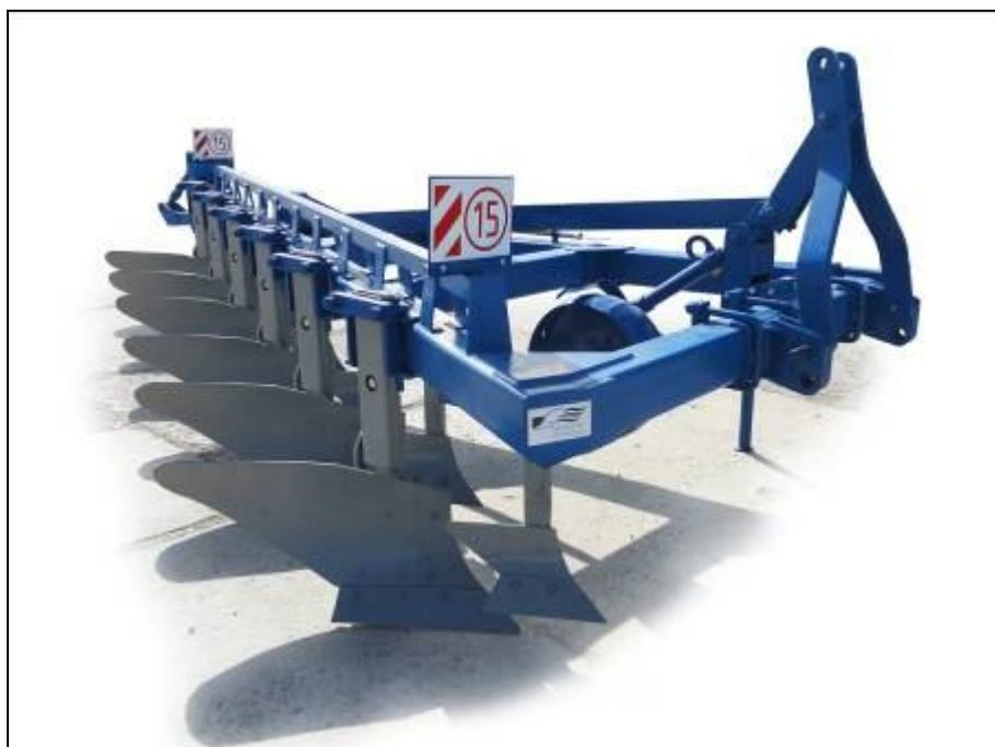
Рисунок 1 – Плуг ПНУ-6×35П, в положении хранения, вид спереди справа
