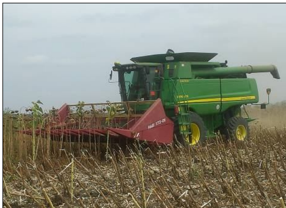
Рисунок 2 – Приспособление для уборки подсолнечника НАШ-873-06 с комбайном JOHN DEERE 9670 STS на уборке подсолнечника
