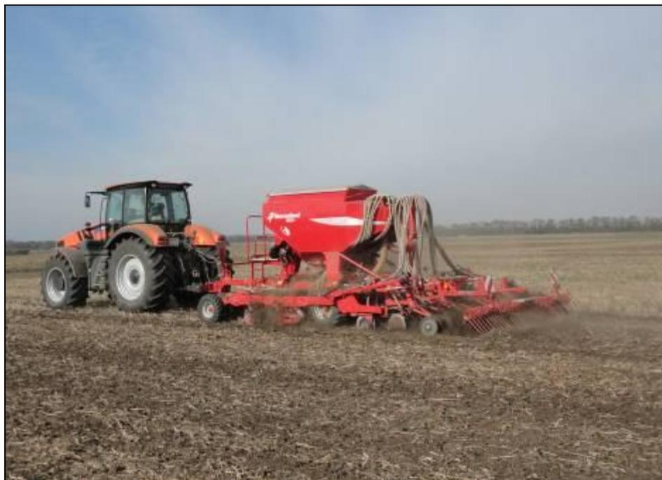
Рисунок 3 – Сеялка зерновая MSC Kverneland в агрегате с трактором АТМ 7360 TERRION на посеве озимой пшеницы
