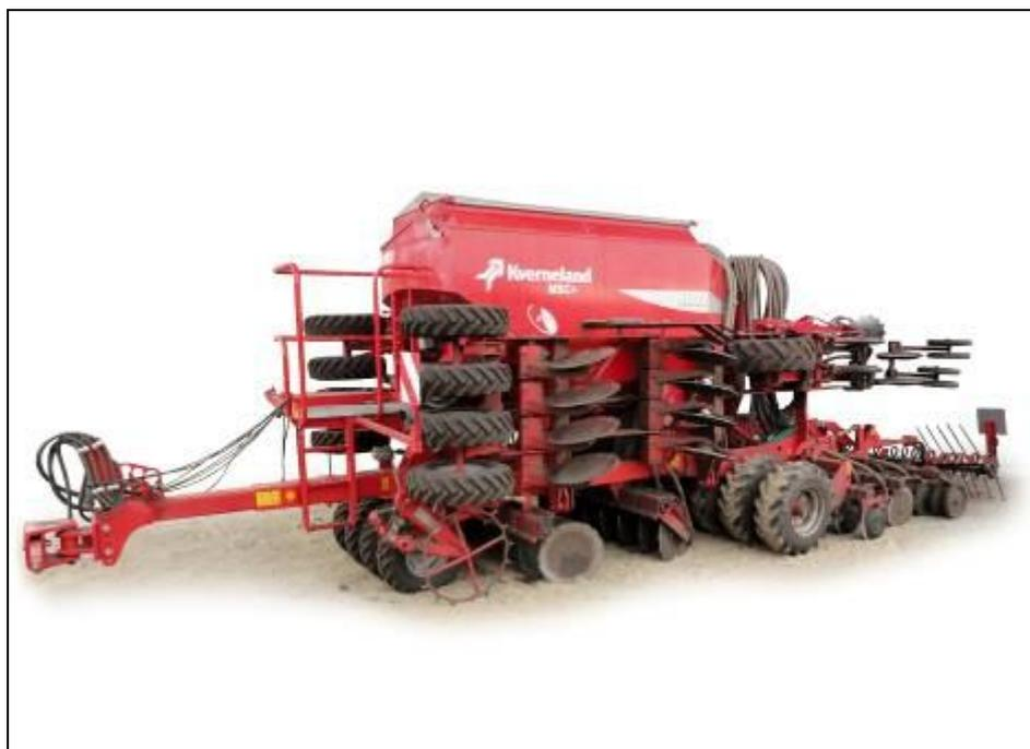
Рисунок 1 – Сеялка зерновая MSC Kverneland в транспортном положении, вид спереди слева
