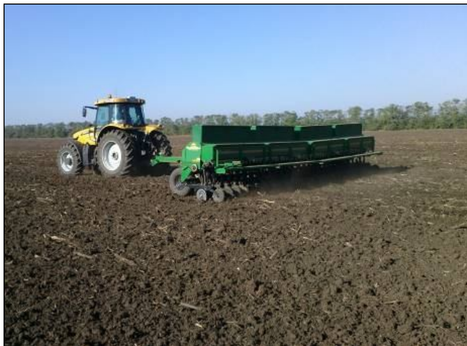
Рисунок 4 – Сеялка GREAT PLAINS 2SF30-6006 в агрегате с трактором Challenger MT575B на посеве озимой пшеницы
