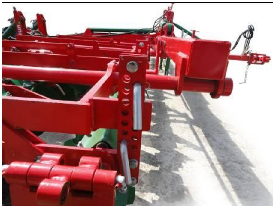
Рисунок 3 – Регулировка изменения глубины хода рабочих органов
