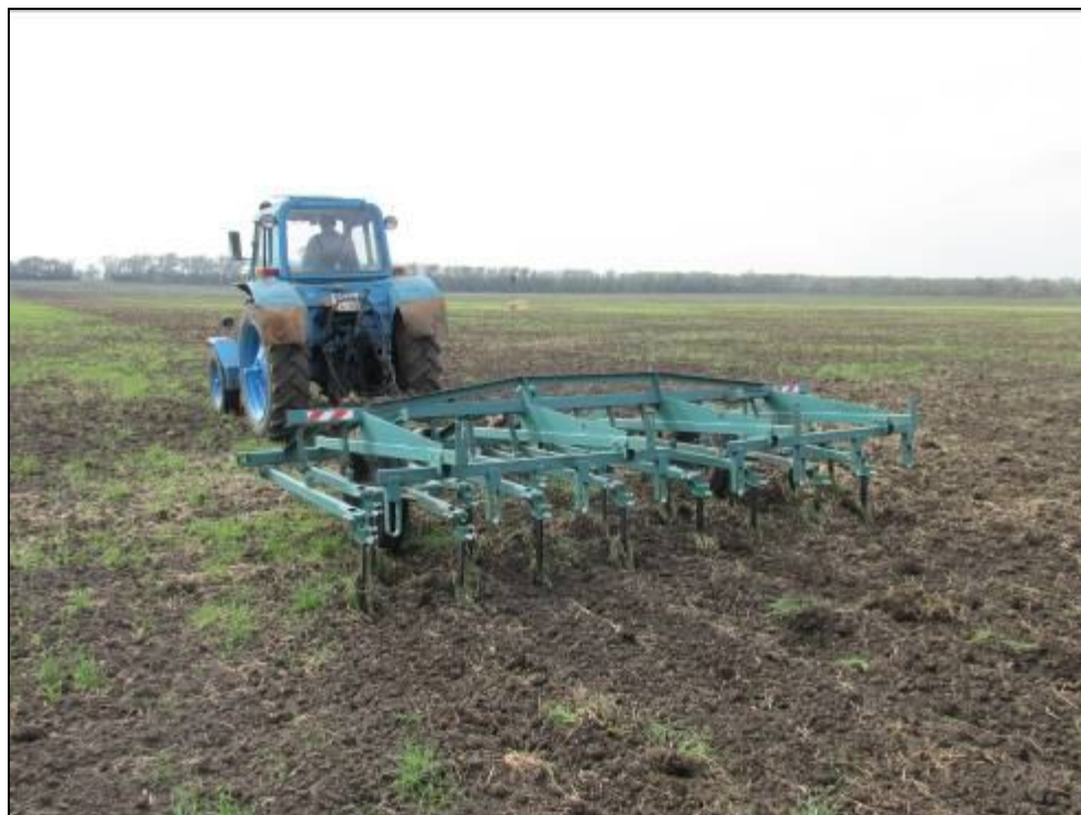
Рисунок 2 – Культиватор КСОГ-4/2, в агрегате с трактором МТЗ-80, на предпосевной культивации
