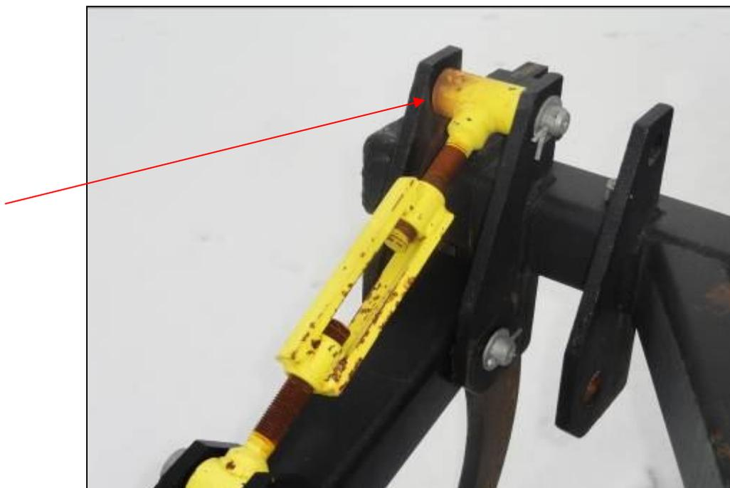
Рисунок А.1 – Смещение крепления опорного колеса и механизма регулировки глубины обработки, установка дополнительного крепления
