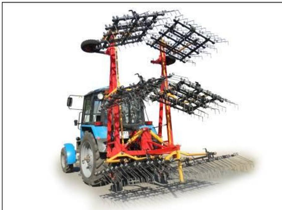
Рисунок 4 – Борона штригельная БШ-9Н в агрегате с трактором МТЗ-82, в транспортном положении, вид сзади слева
