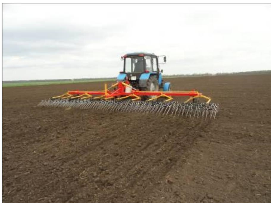
Рисунок 5 – Борона штригельная БШ-9Н в агрегате с трактором МТЗ-82 в работе, на довсходовом бороновании посевов сои
