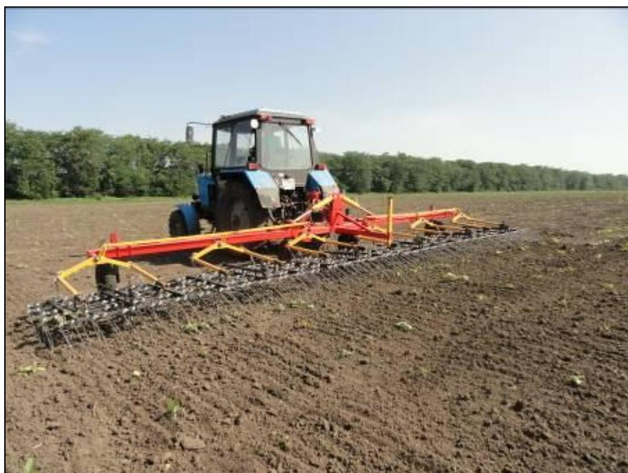
Рисунок 6 – Борона штригельная БШ-9Н в агрегате с трактором МТЗ-82 в работе, на повсходовом бороновании подсолнечника
