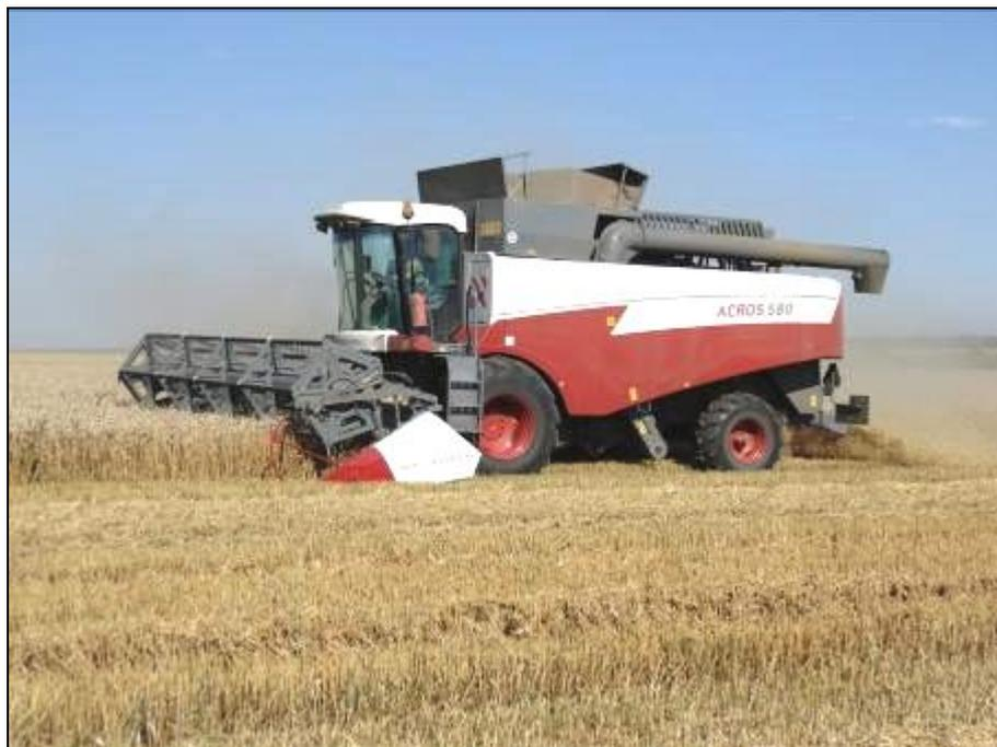
Рисунок 2 – Жатка соевая унифицированная ЖСУ-700 в агрегате с зерноуборочным комбайном РСМ-142 "ACROS 580" на уборке озимой пшеницы
