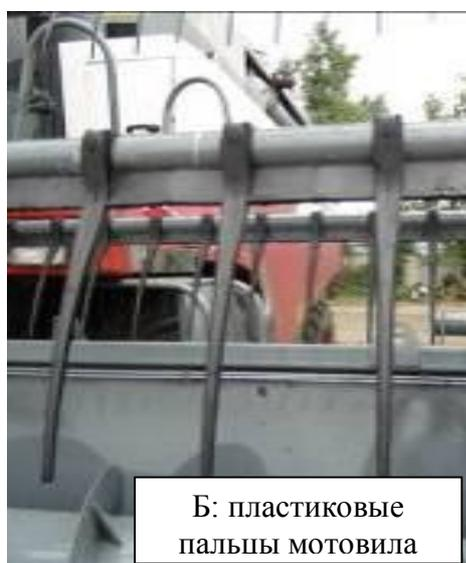
Рисунок 6 – Пальцы мотовила стальные (А) и пластиковые (Б)
