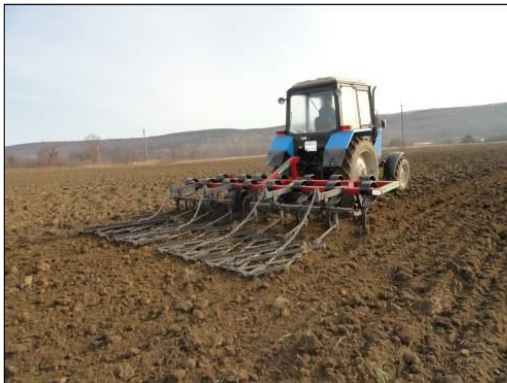
Рисунок 6 Культиватор вибрационный навесной КВН-4,25 в агрегате с трактором МТЗ-82.1, на сплошной культивации
