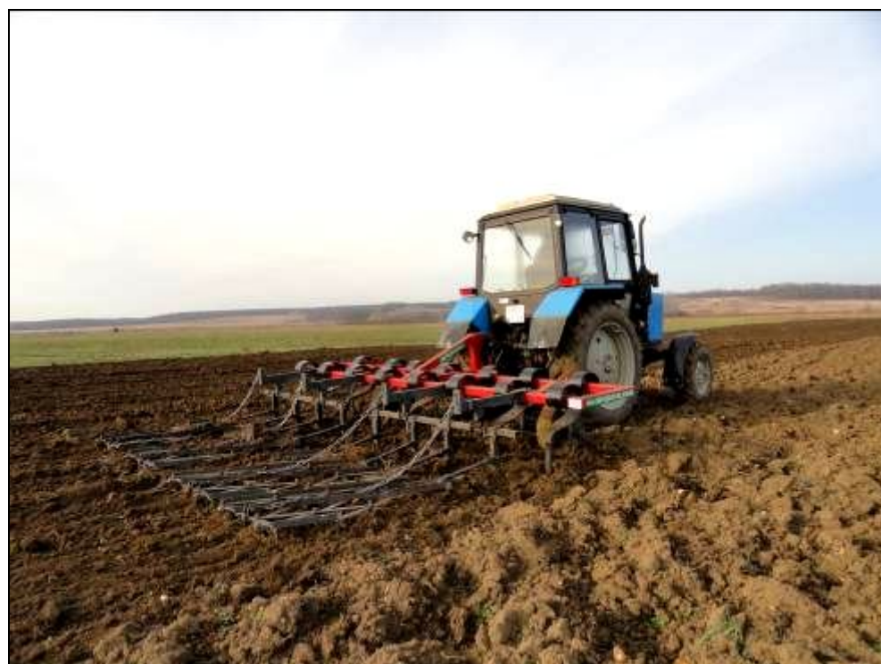
Рисунок 5. Культиватор вибрационный навесной КВН-4,25 в агрегате с трактором МТЗ-82.1, на весенней культивации зяби
