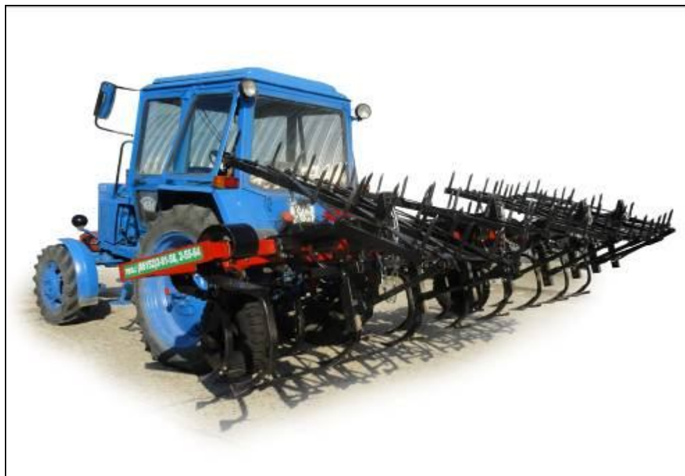
Рисунок 4 – Культиватор вибрационный навесной КВН-4,25 в агрегате с трактором МТЗ-82, в транспортном положении
