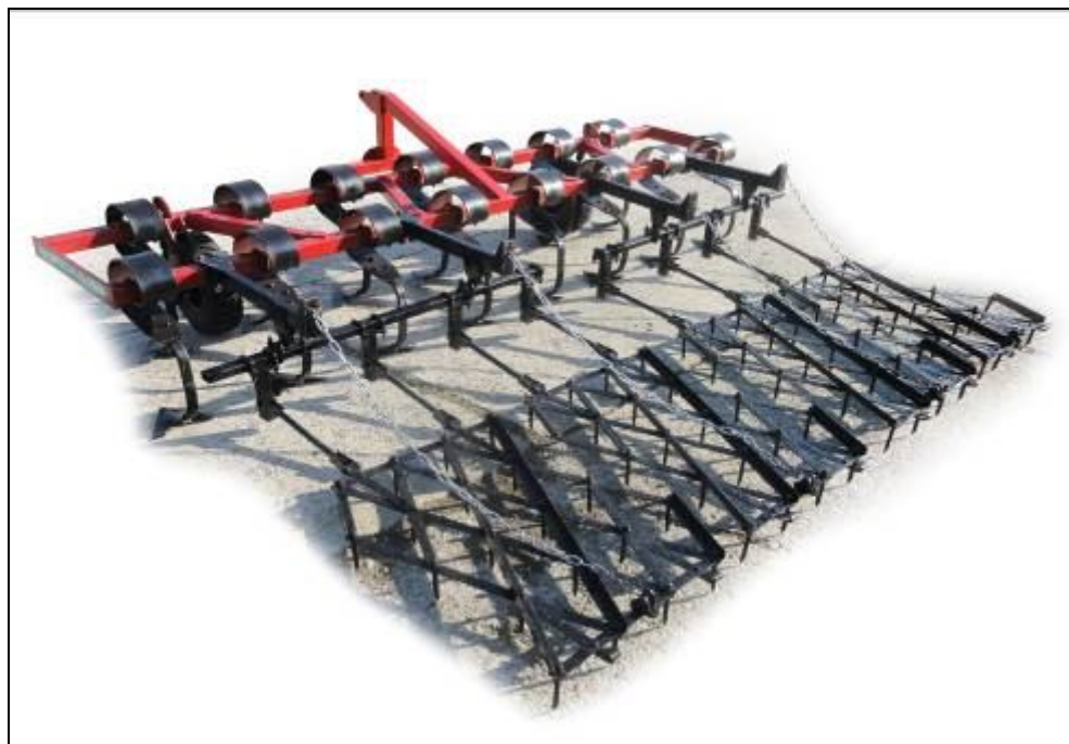
Рисунок 2 – Культиватор вибрационный навесной КВН-4,25, вид сзади слева
