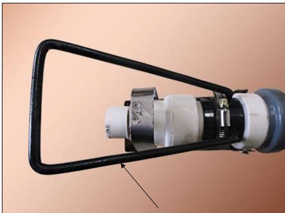
Рисунок 7 – Упор для предотвращения забивания трубчатого наконечника
