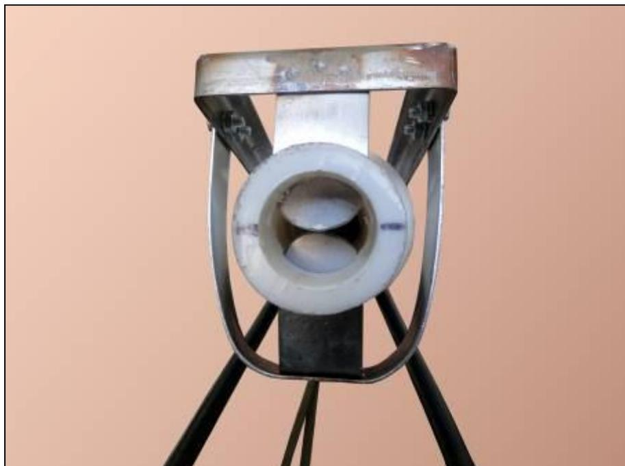
Рисунок 8 – Неподвижный трубчатый наконечник с пластинчатым клапаном
