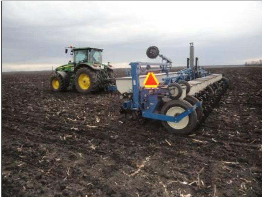
Рисунок 8 – Сеялка KINZE 3600 пропашная 16-рядная в агрегате с трактором John Deere 7830 на посеве кукурузы
