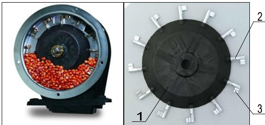
Рисунок 4 – Высеваящий аппарат пальцевого типа: 1 - диск, 2 - палец, 3 - пластина прижима семян
