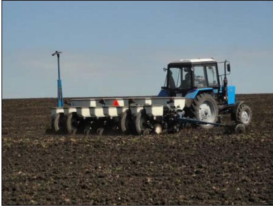
Рисунок 7 – Сеялка KINZE 3000 пропашная 8-рядная в агрегате с трактором МТЗ-82.1 в работе, на посеве кукурузы
