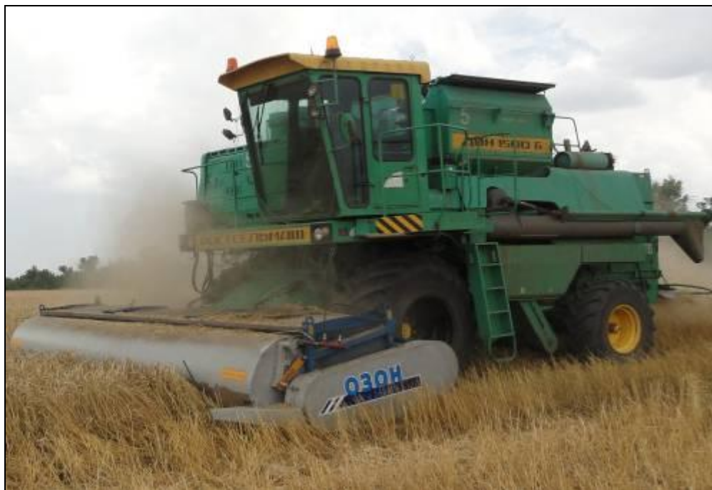
Рисунок 2 – Жатка ЖО-6 с комбайном Дон-1500Б, на прямом комбайнировании озимой пшеницы
