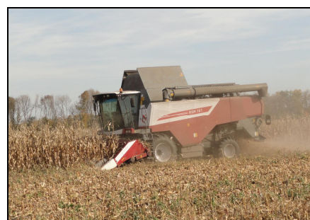
Приспособление ППК-121-29 в агрегате с зерноуборочным комбайном РСМ-161 на уборке кукурузы на зерно
