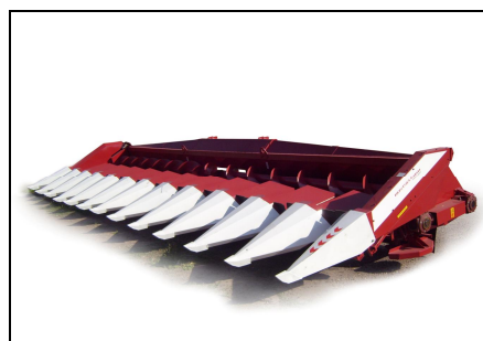
Приспособление для уборки кукурузы на зерно ППК-121-29, вид спереди слева
