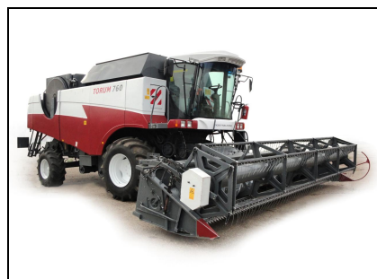
Комбайн зерноуборочный РСМ-181 "TORUM-760" с двигателем Cummins QSX-11.9 с жаткой РСМ-081.27-10, вид спереди справа
