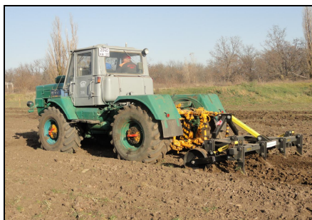
Глубокорыхлитель навесной ГРН-3 в агрегате с трактором Т-150К в работе
