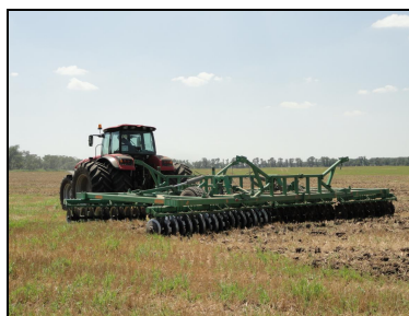
Трактор "Беларус" 3522 в агрегате с бороной БД-9,3 на дисковом лущении стерни озимой пшеницы
