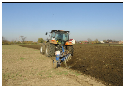
Плуг ПНР-(4+1)х45П в агрегате с трактором АТМ 3180М на отвальной вспашке
