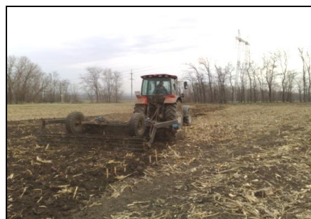
Борона дисковая БДУ-4х2П в агрегате с трактором Беларус 1523В на дисковом лущении стерни кукурузы (2 след)
