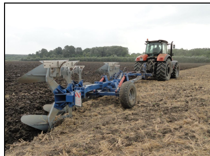
Плуг ППО-(5+1+1)х40П в агрегате с трактором АТМ 7360 на отвальной вспашке
