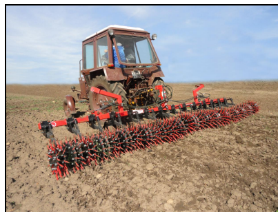
Борона ротационная кольчатая БРК-5,6 в агрегате с трактором МТЗ-80 на подготовке почвы под посев сои
