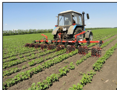
Борона ротационная кольчатая БРК-5,6 в агрегате с трактором МТЗ-1021, на междурядной обработке посевов сои
