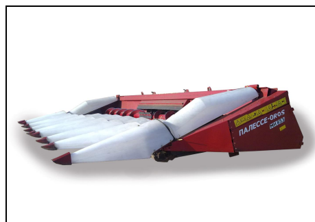
Комплект оборудования для уборки кукурузы на зерно КОК-8-2 (вид спереди слева)
