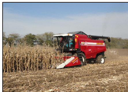
Комплект оборудования для уборки кукурузы на зерно КОК-8-2 с комбайном зерноуборочным КЗС-1218 "ПАЛЕССЕ GS-12", в работе
