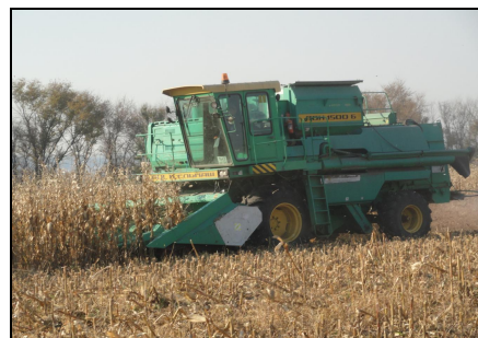
Жатка КМС-8 в агрегате с комбайном Дон-1500Б на уборке кукурузы на зерно
