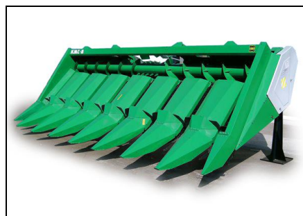
Жатка для уборки кукурузы на зерно КМС-8, вид спереди слева
